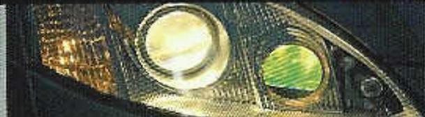
Ins Bild gesetzt: Eine infrarotempfindliche Kamera empfängt die Szenen und übermittelt das Bild an das Display im Kombi-Instrument.
